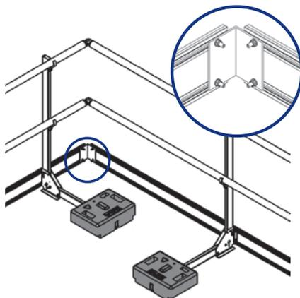
Insérez les vis exactement dans le guide des plinthes, vissez-les sur le connecteur d'angle et serrez.
