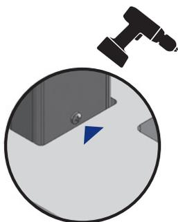
Insérez le montant (poteau) dans l'évidement prévu sur le poids (lestage).
