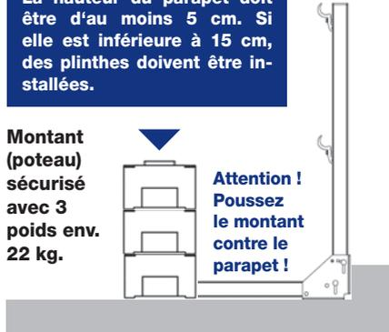
Lorsque vous fixez la vis du lestage sur la traverse, veillez absolument à ce que l'étanchéité existante ne soit pas endommagée !
