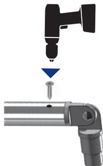
Fixez la main courante et la genouillère au connecteur d'angle à l'aide de la vis auto-taraudeuse fournie..
