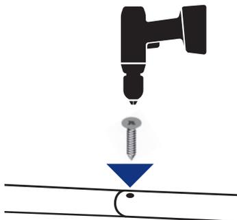
Après avoir relié les deux tubes, fixez-les à l'endroit du trou pré-percé à l'aide de la vis auto-taraudeuse fournie.
