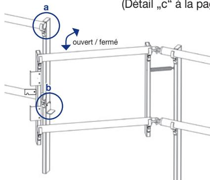
Pour des garde-corps inclinés, la porte du système de garde-corps RAIL doit s'ouvrir vers l'extérieur !
