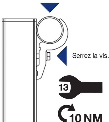
**Attention ! Le bord supérieur de la main courante du système de protection latérale doit se trouver au moins 100 cm au-dessus de la surface de travail.**
